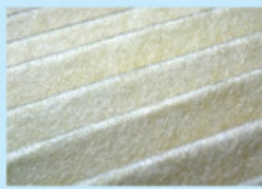
ハイブリッド1 B層 不織布メルトブレン プリーツフィルター (帯電エレクトリックろ過方式)
