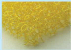
ハイブリッド1 A層 低圧損・中空多面積ウレタンフィルター
